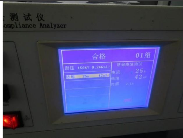
79) Hi-pot check & Earth continuity check
