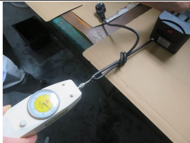
83) Strain relief check
