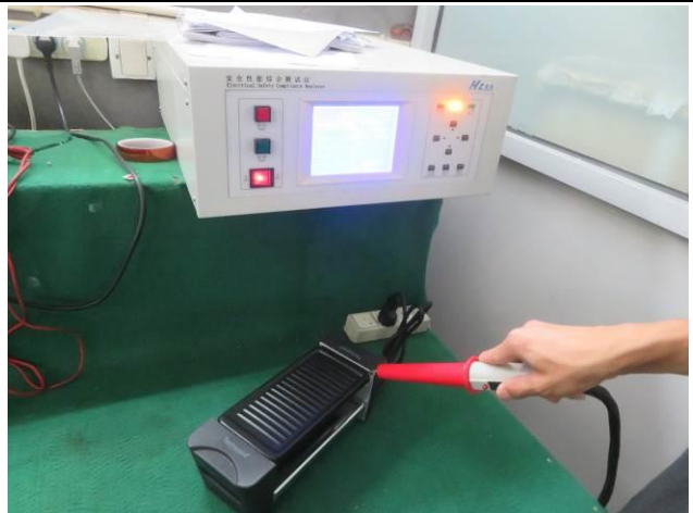
78) Hi-pot check & Earth continuity check
